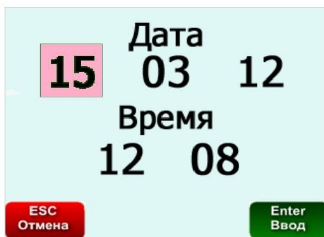
Figure 9 - «Уст. Времени» (time setting) submenu.
